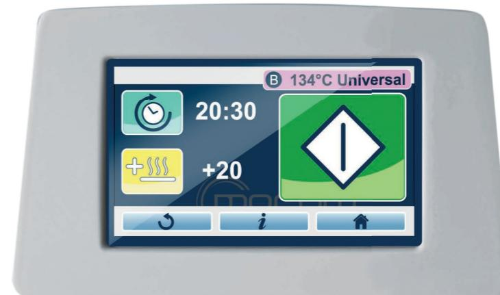
Koncipovaný pro optimalizaci toku práce, sterilizátor B Futura nabízí možnost naprogramování startu sterilizačních cyklů a testů v nejvhodnějších časových pásmech z pohledu energetické spotřeby, aby se zamezilo přetížení elektrického okruhu způsobeného současným používáním více zařízení nebo jednoduše, aby byl sterilizátor již připraven na začátku pracovního dne.
